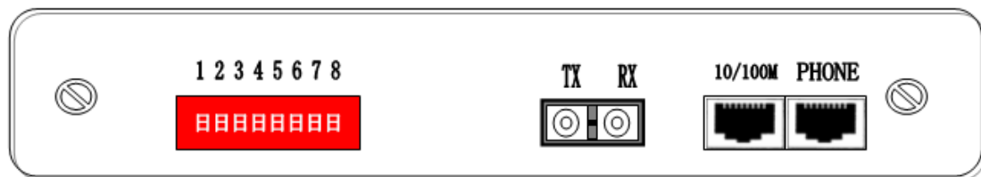
图 2. 复用设备后面板图
