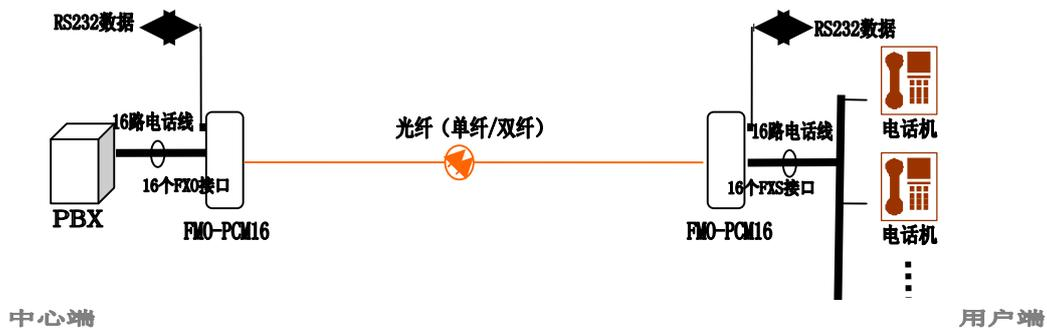
图 3 16 话光端机应用图例
