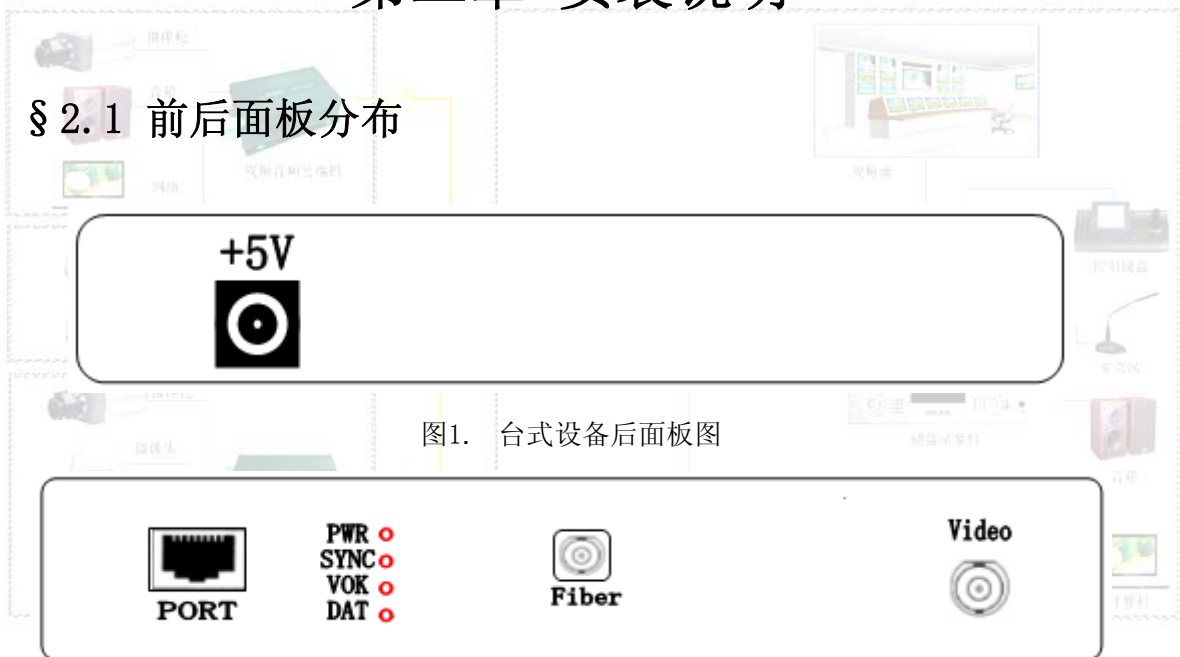
图2. 台式设备前面板图
