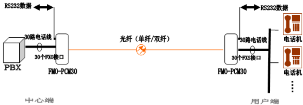
图 3 30 路电话光端机应用图例
